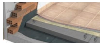
L'intervento di isolamento di un tetto piano risulta semplice ed efficace anche in fase di ristrutturazione con la posa dei pannelli **Neodur® SB 030**. La battentatura sui quattro lati elimina le dispersioni termiche e l'elevata resistenza meccanica garantisce ottimi risultati anche in presenza di alti carichi.
